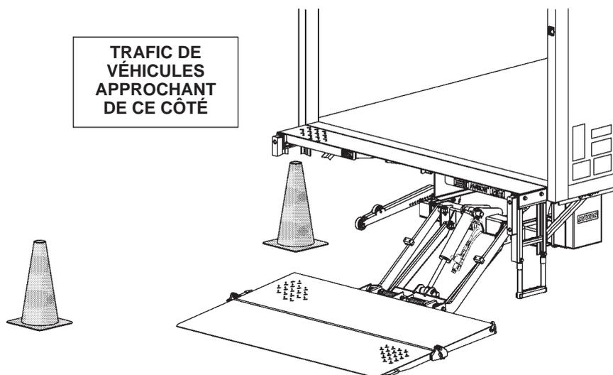
CÔNES DE TRAFIC POSITIONNÉS À CÔTÉ DE LA ZONE DE CHARGEMENT DE LA PLATE-FORME
