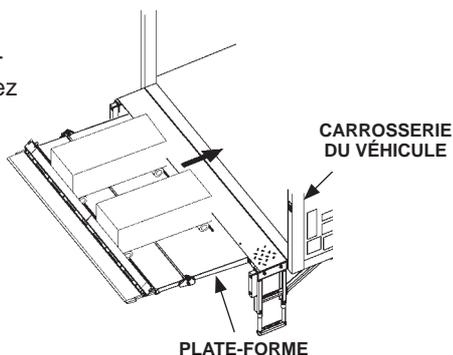
**DÉCHARGER LA PLATE-FORME À HAUTEUR DE PLANCHER (BUTÉES D'ARRÊT DOUBLES OUVERTES)**
