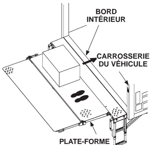
**CHARGER LA PLATE-FORME À HAUTEUR DE PLANCHER**
