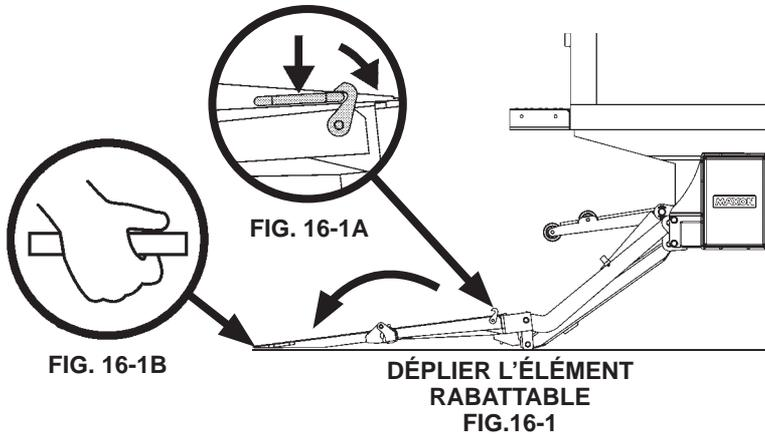
**REMARQUE :** lors de l'utilisation du hayon, relâchez l'interrupteur à bascule pour arrêter la plate-forme.
