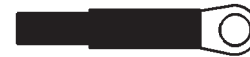
TÍPICO CABLE DE ALIM. CON PORTAFUSIBLE CON TERMINAL DE OJILLO INSTALADA FIG. 61-2
