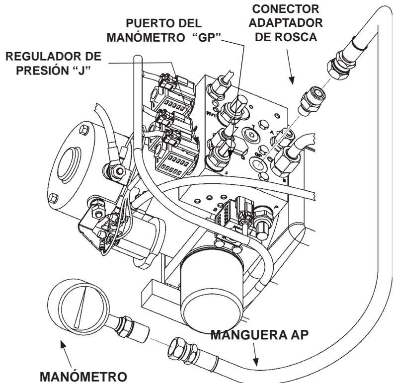
**CONEXIÓN DEL MANÓMETRO Y REGULADOR DE PRESIÓN EN LA PLACA DEL PUERTO**
