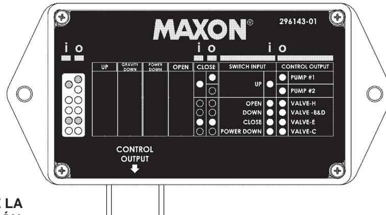
**INDICACIONES DEL CONTROLADOR PARA LA FUNCIÓN DE REPLIEGUE
