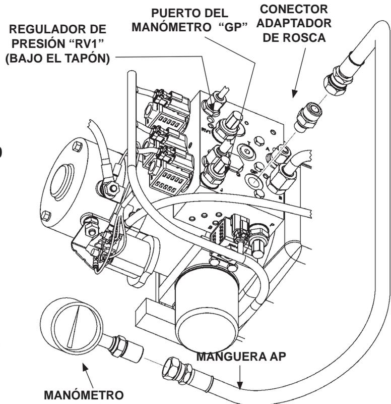
**CONEXIÓN DEL MANÓMETRO Y REGULADOR DE PRESIÓN EN LA PLACA DEL PUERTO (SE MUESTRA BOMBA DE DESCENSO ASISTIDO)**
