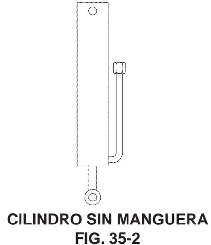
**NOTA:** Consiga un ayudante antes de instalar un nuevo cilindro. Con el cilindro abajo, haga que el ayudante vea a través del orificio cuadrado de inspección en la parte posterior de la corredera. El ayudante informará al instalador cuando el extremo del vástago esté alineado con el pasador inferior.
