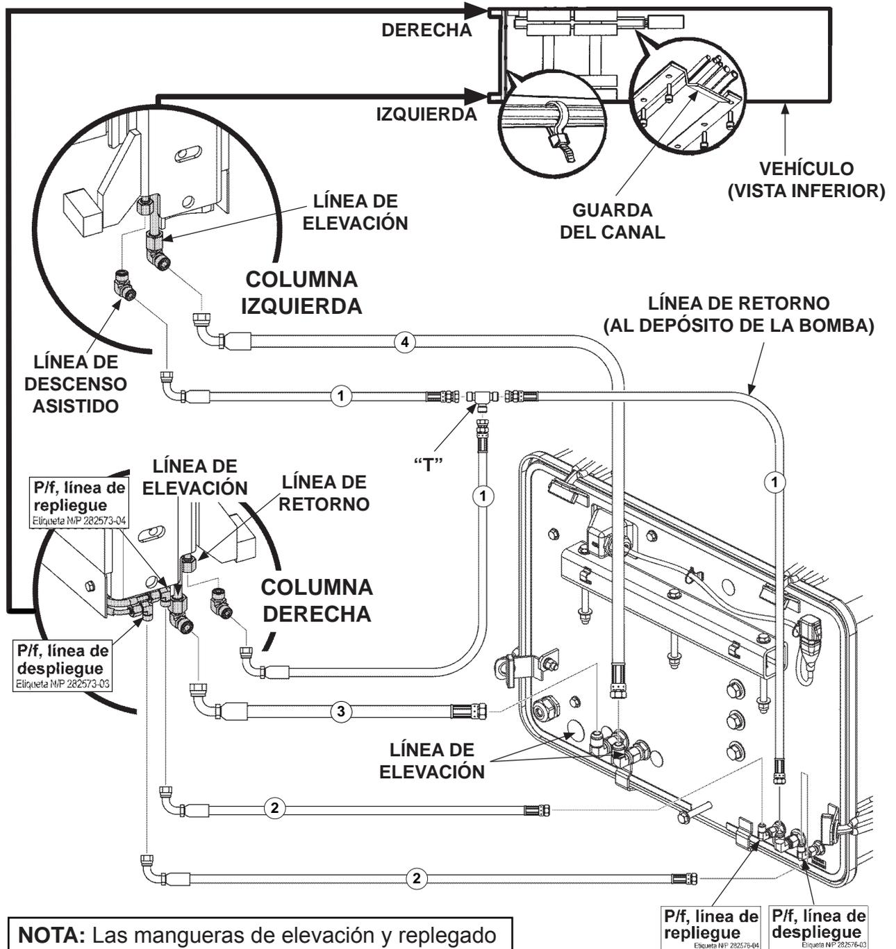
**NOTA:** Las mangueras de elevación y repliegado corren hacia arriba desde los conectores de la columna hacia el piso del vehículo.
