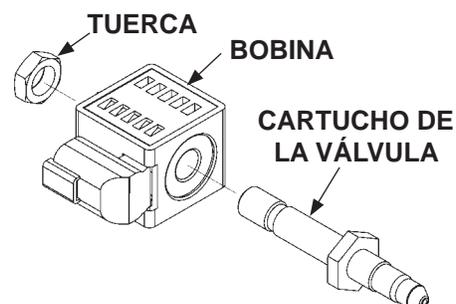
VÁLVULA SOLENOIDE TÍPICA DESMONTADA Y DESARMADA
