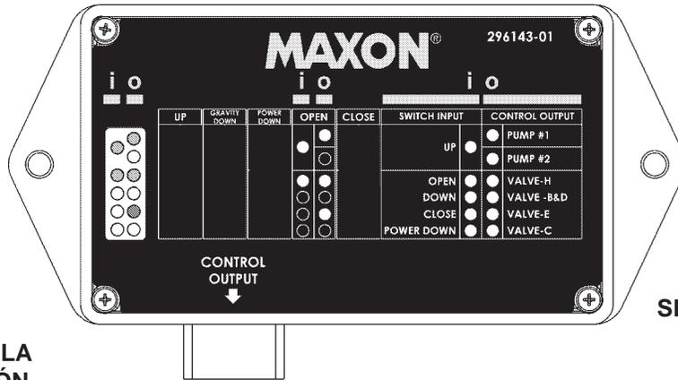
**INDICACIONES DEL CONTROLADOR PARA LA FUNCIÓN DE DESPLIEGUE
