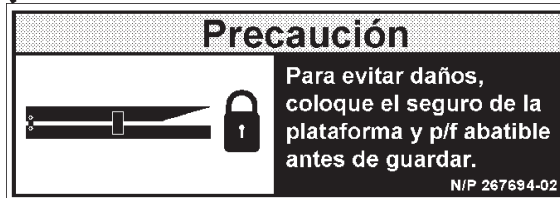
ETIQUETA DE PRECAUCIÓN (SOLO EN PLATAFORMA ABATIBLE EQUIPADA CON PESTILLO) N/P 267694-02
