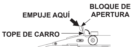
CERRAR LOS TOPES DE CARRO (VISTA DER. DE LA PLATAFORMA ABATIBLE) FIG. 27-2
