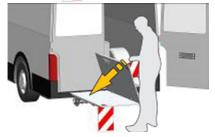
17. Pliegue el lado derecho de la plataforma del elevador manualmente.
