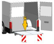
5. Baje la plataforma del elevador usando el panel de control (Bajar) o, si está parado en la plataforma, usando los controles de pie o el control manual opcional (Bajar) para poder abrir la puerta izquierda del vehículo.
