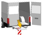
3. Abra la plataforma del elevador usando el panel de control (Abrir / Inclinar hacia abajo) o el control de mano de 3 botones opcional (Inclinar hacia arriba / Inclinar hacia abajo) + (Bajar).
