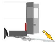
9. Incline hacia abajo la punta de la plataforma del elevador usando el panel de control (Abrir / Inclinar hacia abajo) o, si está parado en la plataforma, usando los controles de pie o el control de mano opcional de 3 botones (Inclinar hacia arriba / Inclinar hacia abajo) + (Bajar).
