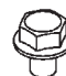
PERNO DE CABEZA HEXAGONAL CON BRIDA M8 X 12 MM DE LARGO N/P 901610-01 CANT. 2
