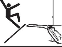
**NEVER OPERATE LIFTGATE WHEN WALK RAMP IS EXTENDED.**
